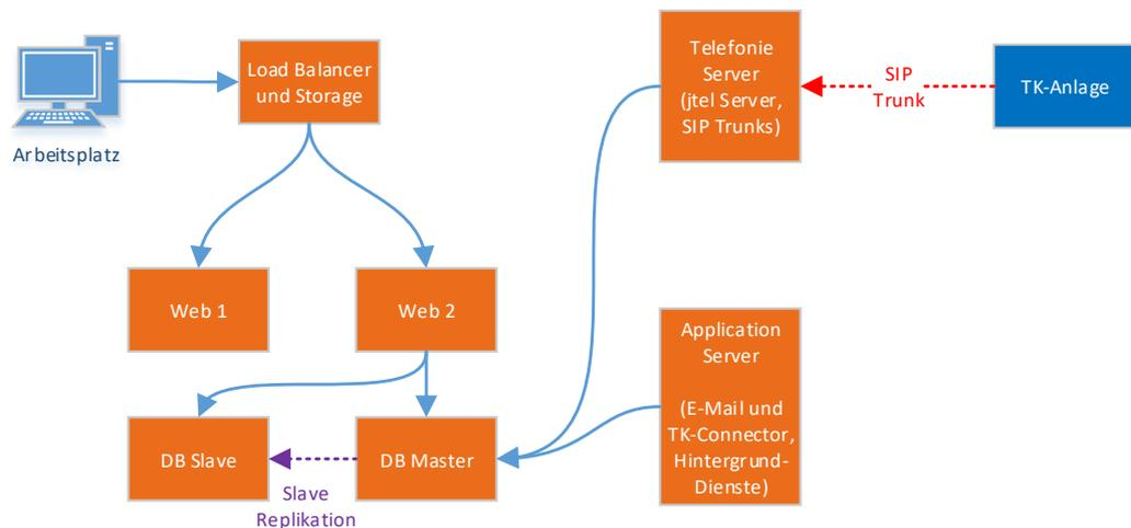
Abbildung 1 – Systemdiagramm
